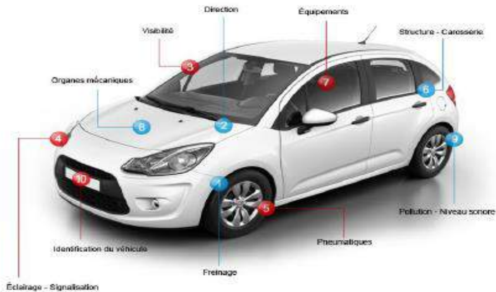
Figure 8 : Les 10 fonctions mécaniques vérifiées
